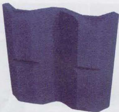
O Anglesoftner foi desenvolvido para ser aplicado nas esquinas horizontais ou verticais das salas. É um painel absorvente de médias frequências que, quando aplicado nos cantos a 90°, revela também a sua eficácia em frequências mais baixas, uma vez que cria uma câmara-de-ar entre o painel e a parede
